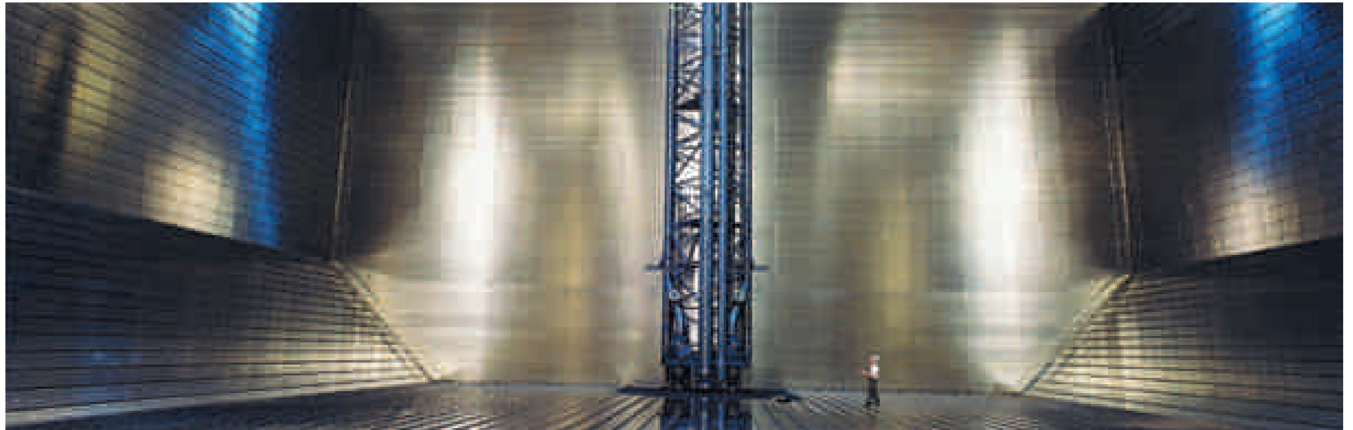
Tanque de carga del buque LNG "Íñigo Tapias"
