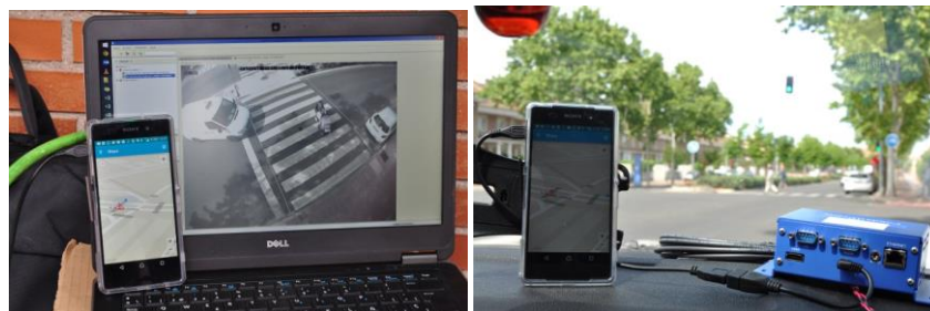
Figura 2. Detalle Cruce Inteligente, visualización de la Cámara y Alerta de presencia peatones en vehículo embarcado
