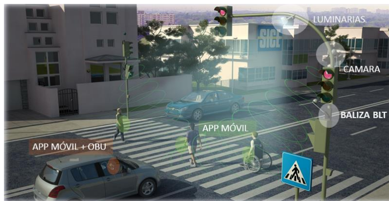
Figura 1. Arquitectura del Cruce Inteligente (SAFECROSS 2.0)
