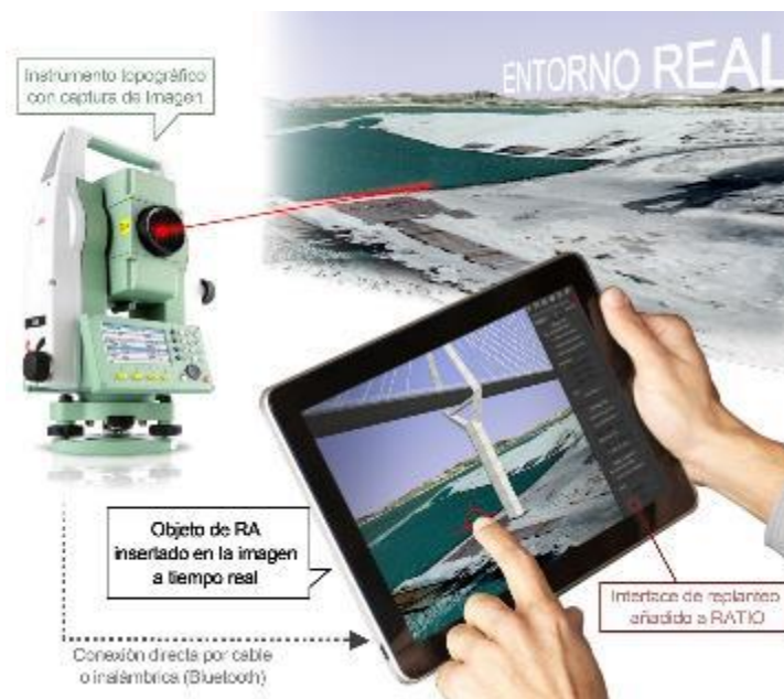
Ilustración 1 Esquema básico de funcionamiento del sistema RATIO
