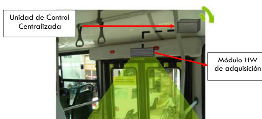
Módulo adquisición y Unidad de control centralizada.
