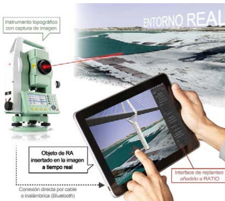
Esquema básico de funcionamiento del sistema RATIO.
